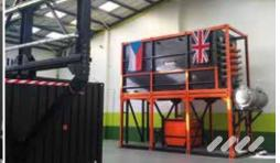
Сам процесс медленного термического разложения (PTR) занимает около 2–3 часов и происходит в замкнутой системе без доступа воздуха. Процесс PTR, как таковой, является термически стабильным, и во время его прохождения из входной партии непрерывно образуются **три выходные фракции: газообразная, жидкая и твердая.** В зависимости от конечного применения этих фракций выходы процесса PTR сертифицируются как топливо, например, HEDGAS (*PTR газ*), HEDOIL (*PTR масло*) и HEDCARB (*PTR углерод*).\*
